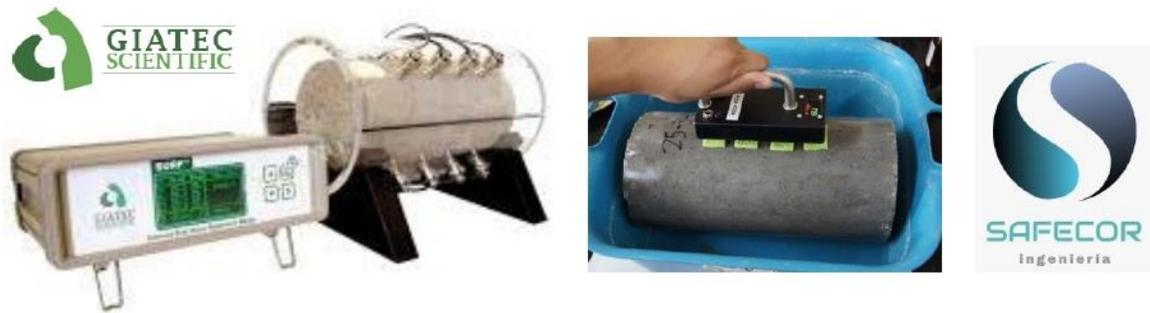
Figura 4. Equipos que se utilizan para las mediciones de  $\rho_s$  superficial en cilindros de concreto.
