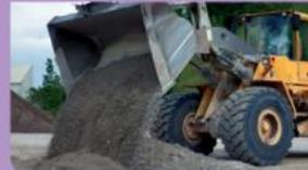
Después de mezclar durante unos minutos con Re-Con Zero el concreto se transforma en material granular que una vez curado, se utiliza como agregado de un nuevo concreto. La revolvedora queda limpia y el agua usada en la limpieza puede ser completamente reciclada y utilizada de nuevo para la mezcla.
