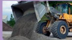
Después de mezclar durante unos minutos con Re-Con Zero el concreto se transforma en material granular que una vez curado, se utiliza como agregado de un nuevo concreto. La revoladora queda limpia y el agua usada en la limpieza puede ser completamente reciclada y utilizada de nuevo para la mezcla.
