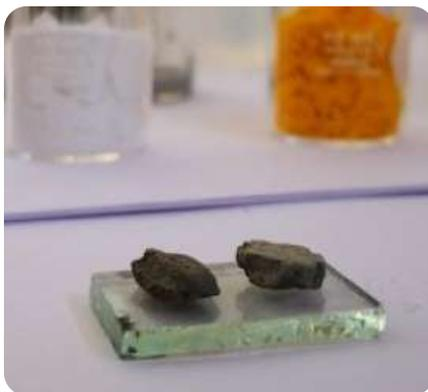
compuestos orgánicos (perovskita) para la generación fotovoltaica, por lo que sintetizando los materiales para crear la perovskita y uniéndolos con el óxido de titanio que se utiliza en la fabricación de celdas Grätzel, empleándolo como matriz que absorbiera radiación solar, que finalmente se transformaría en energía eléctrica.
